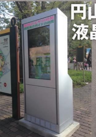
動作する温度の幅が狭い液晶モニタ。屋外でも安定して情報を表示するため、ケース内を夏は冷やし、冬は暖めている。前例がないため、ゼロから試行錯誤しながらの製作だったそうだ。
